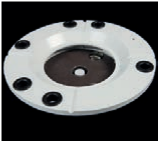
Instalación La placa base se puede instalar en la estructura usando 3 pernos M12 o 4 pernos M12 en un diámetro de 200 mm.
