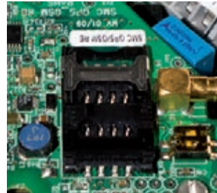
Monitoreo a distancia Unidad y antena GSM integradas a la linterna para monitoreo y control a distancia. Por más información, consulte la sección sobre LightGuard.
