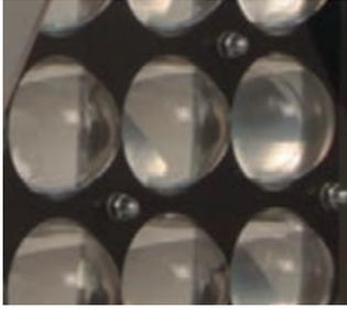
**LEDs de alta potencia y óptica personalizada**
